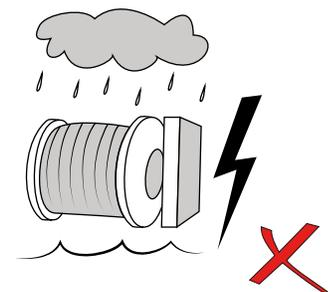
6. Evite el uso del Winche en la lluvia. No moje el interruptor ni el motor.
