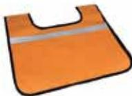
**Amortiguador de Línea:** El propósito de este accesorio es reducir el riesgo de lesiones debido al efecto látigo que se produce en el caso de que en un cable o una correa de recuperación se corte durante la operación. Tiene la forma de una manta con bolsillos para ser llenados con pesos como arena o piedras. Una vez cargado deberá ser doblada alrededor del cable antes de realizar la maniobra de tiro.
